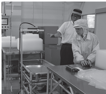
作業手順などをプロジェクションマッピングで映し出す独自開発の作業台
